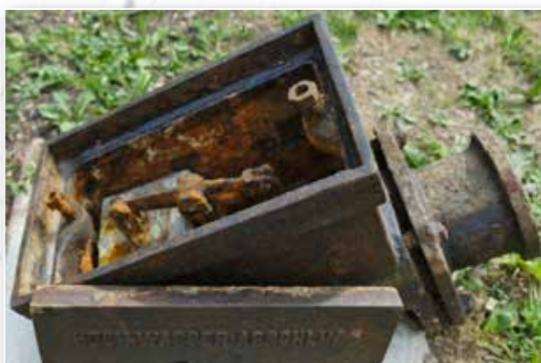
Diese gusseiserne Rückschlagklappe aus dem 19. Jahrhundert wurde in Ohrdrufs Schloss Ehrenstein beim Wiederaufbau geborgen und gibt jetzt vorm Verwaltungsgebäude des Zweckverbandes Kunde vom ingenieurtechnischen Genius unserer Vorfahren.
